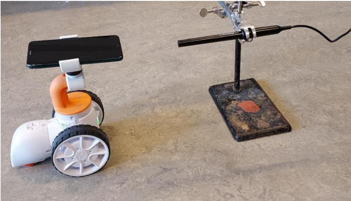
Figur 1 ovenfor: Mikrofonen optager lyden fra mobiltelefonens tonegenerator, mens Robotten kører.
